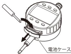
② CR2450 (リチウム電池) を電池ケースにセットし、本体に挿入します。
