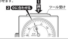
③ 0 点調整つまみを「TEST」から「USE」に、図 のように合わせます。
