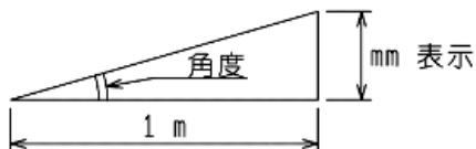
センサーのパネルに印刷された X、Y の矢印側が上になるとプラス表示（マイナス符号表示無し）、下がるとマイナス表示になります。
