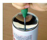
给用过的喷雾罐开孔
