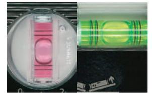
测量水平·垂直的气泡管
