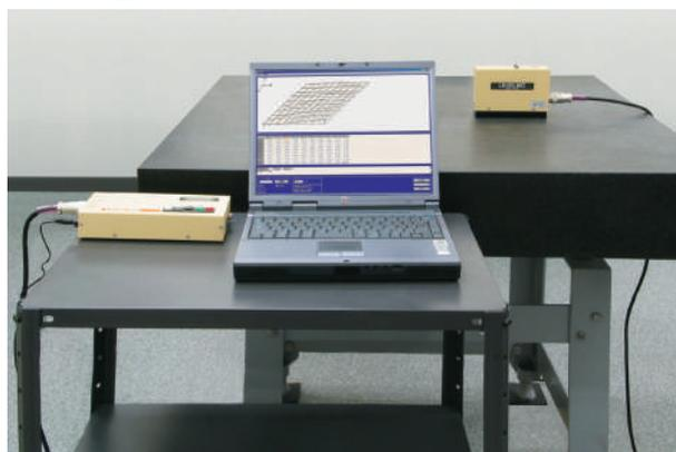
■链接计算机，测量直线度
