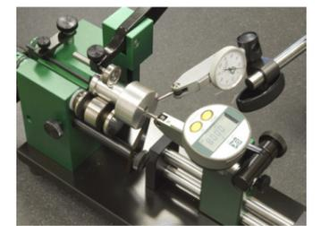
追加了法兰槽式主滚轴 (小径用) 类型, 合计共21种测量模式+可以对应特殊品制作!
