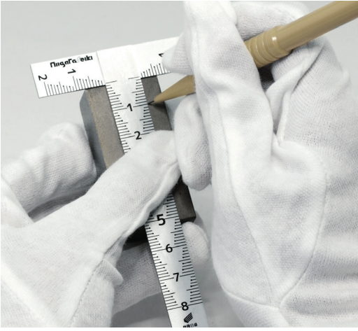
适用于小型工件的加工划线作业
