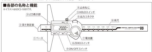
①ベース ············· の面をワークの基準面に当てて測定します。 ⑥出力コネクタ······· 別売の Bluetooth BOX を接続することで、
